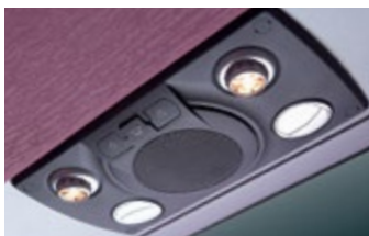
Đèn đọc sách/ Cửa gió điều hòa/ Loa
